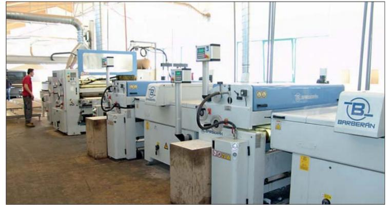
Barberán-Beschichtungsanlage für „Hotcoating“-Oberflächen bei Lico. Hinten links ist noch ein Teil der Durst-Digitaldruckanlage „Rho 750“ erkennbar. Die bedruckten Platten können gleich anschließend durch die „Hotcoating“-Anlage laufen. Rechts neben dem Mitarbeiter ist die Walzenauftragseinheit zu sehen. Dahinter folgen die Anlagen für den Auftrag von UV aushärtendem Acryl-Hochglanzlack. Die ganze Anlage ist weniger als 7 m lang.
