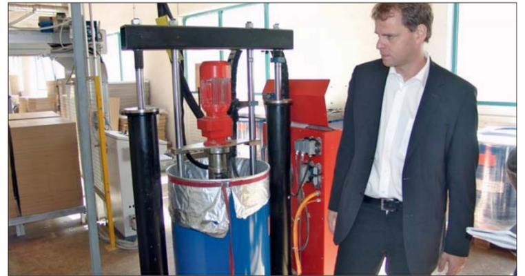
Jens Fandrey neben der Fassschmelzanlage des Schweizer Herstellers Balti AG. Über eine speziell gehärtete Schneckenpumpe (wegen des hohen Korundanteils) wird das nun flüssige PUR-System zur Barberán-Anlage gefördert.
