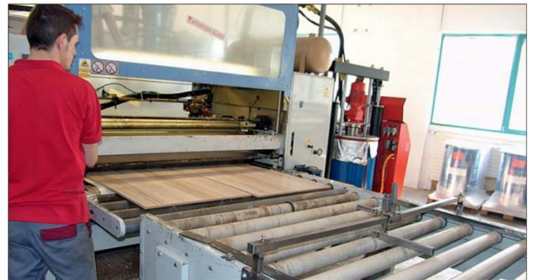
„Hotcoating“-Beschichtung mit drei Walzen (Heißwalze, Auftragswalze und revers laufende Glattwalze)
