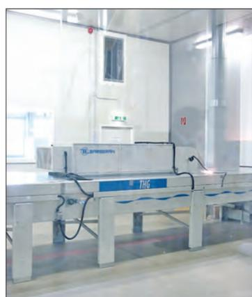
Nach den Topcoats brauchen die Oberflächen Ruhe und laufen über ein Gummitransportband in einem Überdruckkanal zur Trocknung
