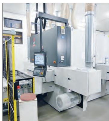
Die Schleifmaschine ist besonders stark ausgelegt und benötigt 250 Ah Stromaufnahme
