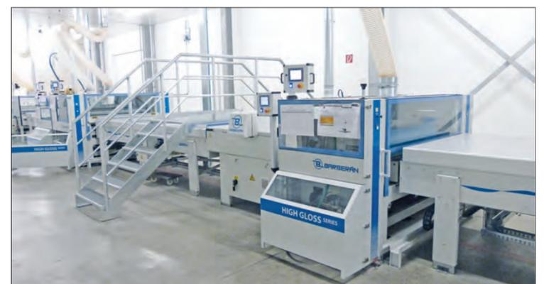
Die Linie beginnt links hinten mit Aufheiz- und „Hot coating“-Station, dann folgen der Lackauftrag zunächst an den beiden Station für den Basecoat 1 entweder pigmentiert oder klar und schließlich der Basecoat 2 (Vordergrund)
