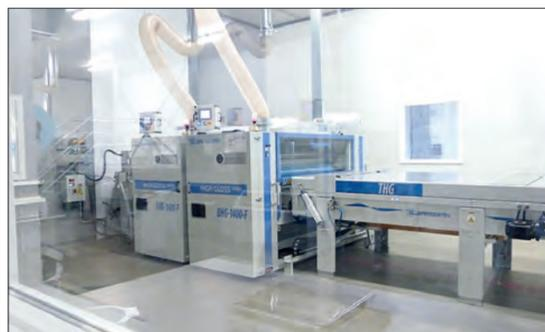
Der sensibelste Bereich des Prozesses findet im Reinraum statt, wo die Topcoats aufgebracht werden mit je einer Maschine für Weiß- und für Transparentlack
