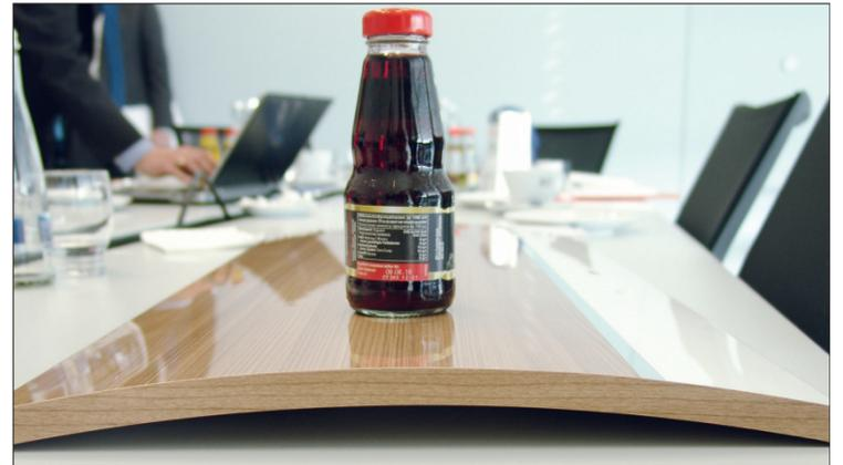
„Hot Coating“ ist nun auch für gebogene Möbelteile möglich. Dabei erfolgt die Verformung allerdings im Anschluss an die Beschichtung
